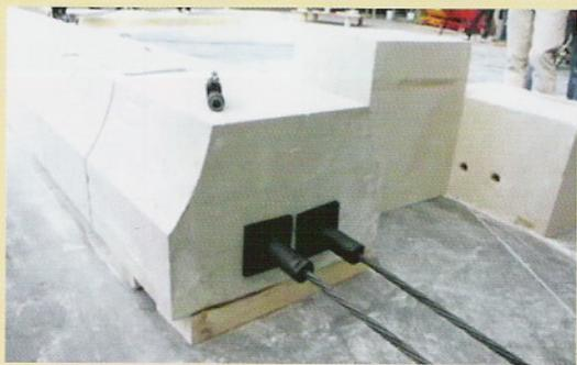
*Cette poutre de 9 m en pierre précontrainte a été réalisée avec des architectes et des élèves tailleurs de pierre au CFA Pont de Vesle.*
